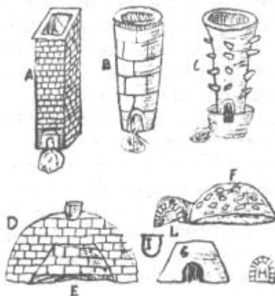
FORMAS DE LOS HORNOS DE FUNDICION INCAICOS. Los de arriba se llaman Huayrachina , y servían para reducir y fundir los minerales; los de abajo reciben el nombre de Toccochimpu , y se usaban para refinar la plata especialmente. Todavía se usan en el país, los hemos visto dos veces en San Lucas, Cinti.
